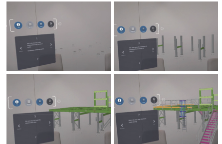
施工手順/作業手順の3D表示
