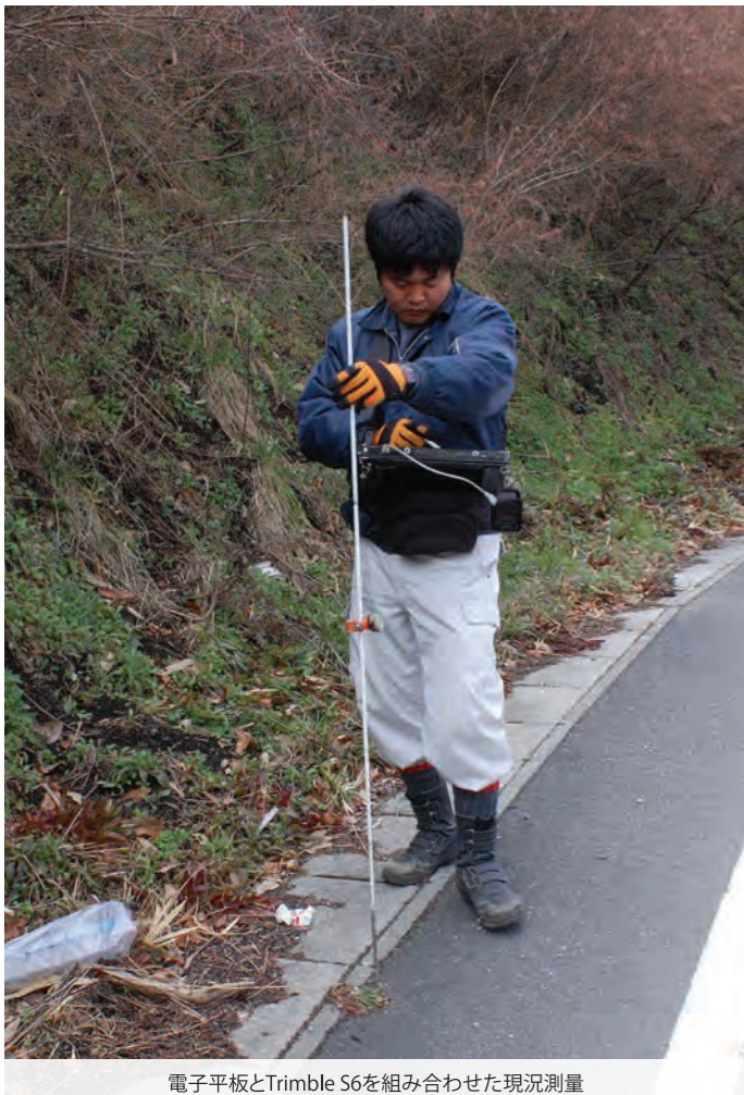
電子平板とTrimble S6を組み合わせた現況測量
