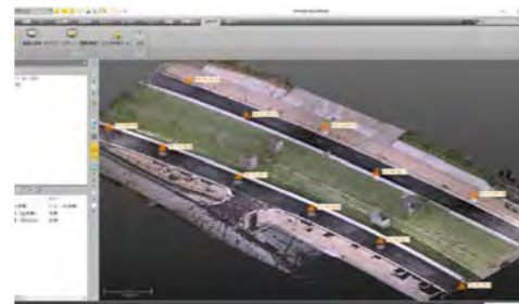
出来形管理の現場を Trimble RealWorks で合成・ノイズ処理
