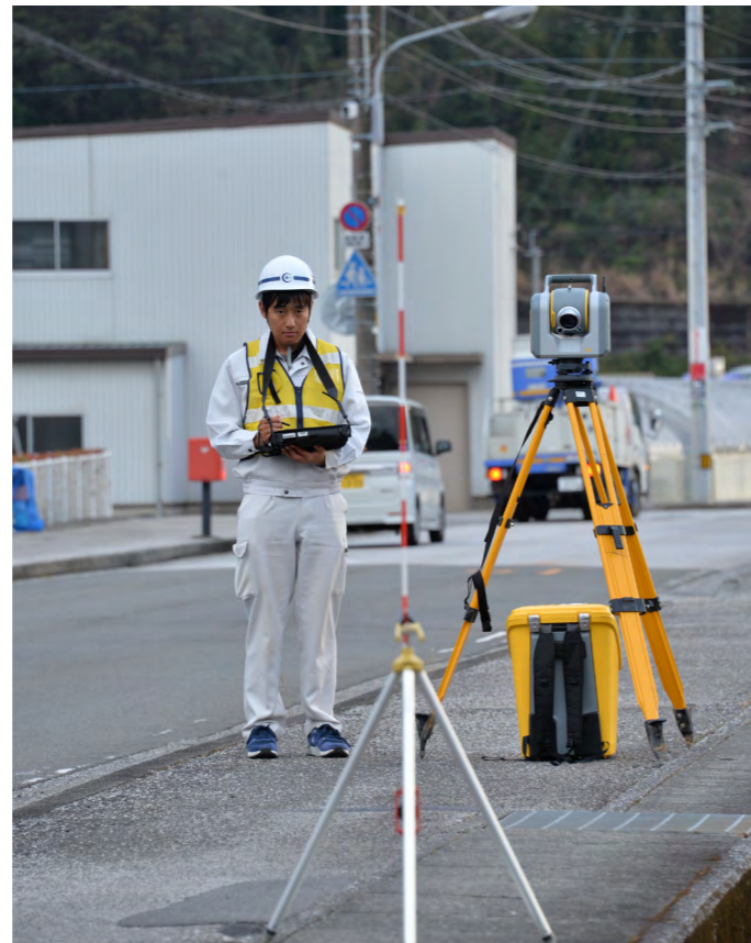
Trimble SX10を使い対空標識の観測を行う森木様(調査部3D計測チーム)
