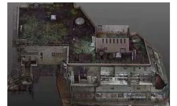
Trimble RealWorksの自動合成により3次元化した建築物
