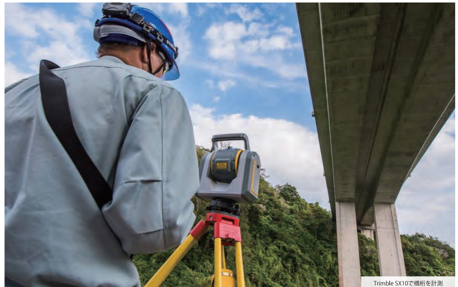
Trimble SX10で橋桁を計測
