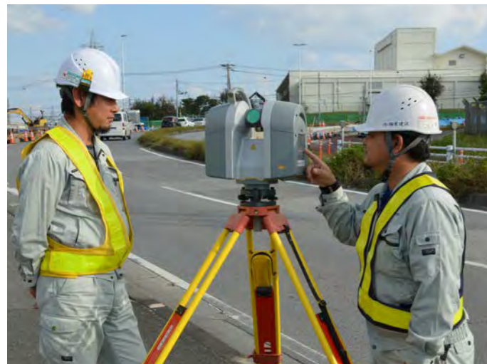
実際の計測現場でTrimble TX8を操作する 金城 様(右)、當真 様(左)
