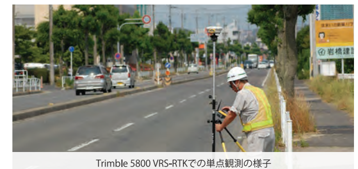
Trimble 5800 VRS-RTKでの単点観測の様子
