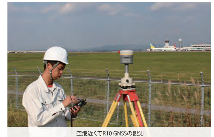
空港近くでR10 GNSSの観測
