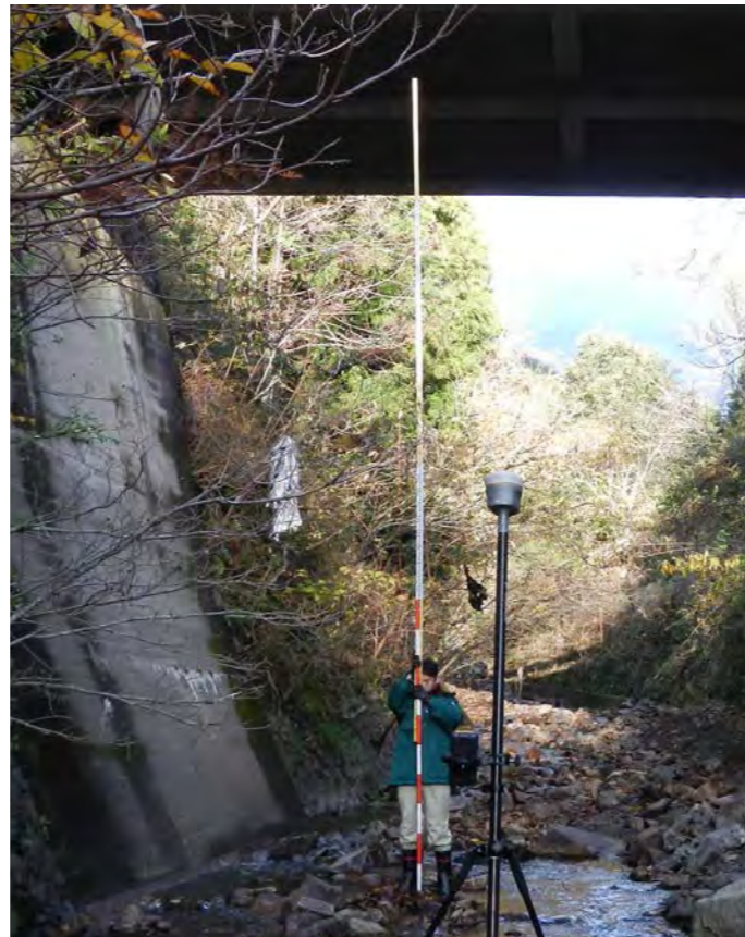
山間地における川底の位置計測。 Trimble R10のHD-GNSSにより素早いFIX解を求めることができる。
