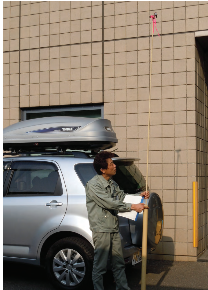
15mまで伸ばせるターゲットポール。これで何分もターゲットを静止させて持つのは、かなり大変です。
