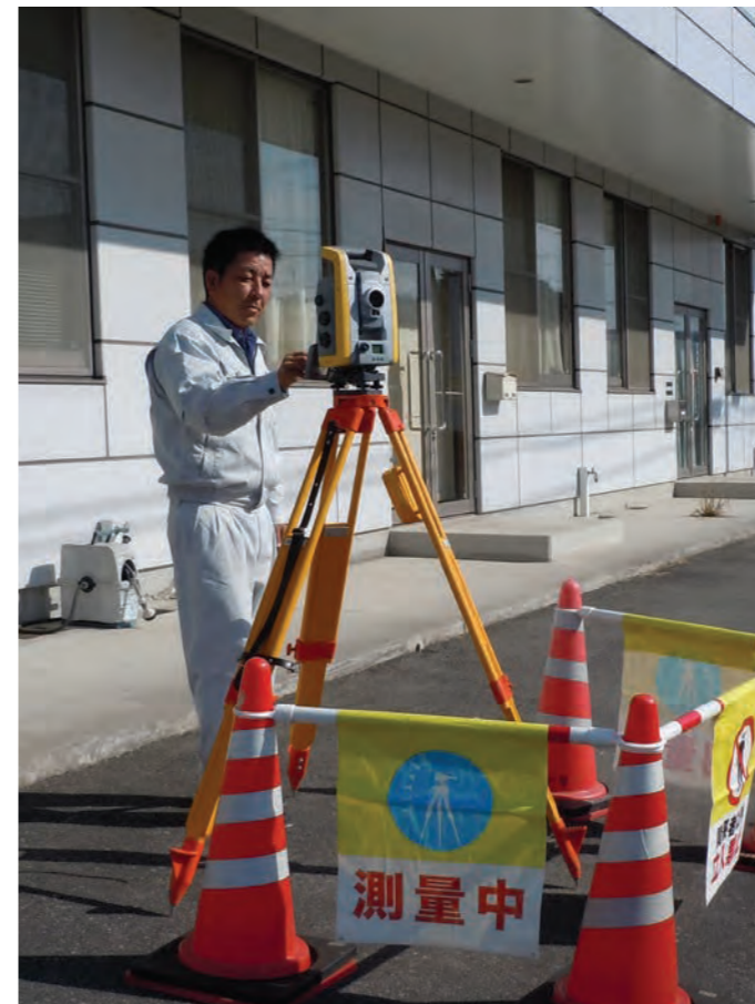
Trimble S6を操作中の代表取締役 尾川様。 ワンマン測量可能とはいえ、器械から離れるのは不安という事で、「測量中」のバナーを特注されたそうです。
