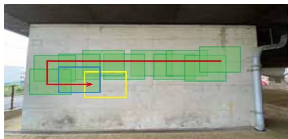
上図は計測のイメージです。撮影したデータはタブレット上で簡易スティッチしていきますので取り漏れ等を防止できます。
