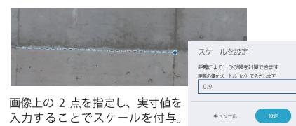
画像上の 2 点を指定し、実寸値を入力することでスケールを付与。スケールに合わせてひびの自動解析を開始
